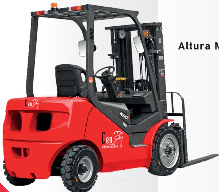
**Capacidad de carga:** 2,000 Kg. a un centro de carga 500 mm
