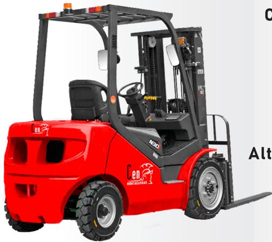
**Capacidad de carga:** 3,000 Kg. a un centro de carga 500 mm
