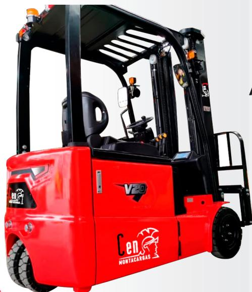
**Capacidad de carga:** 1,600 Kg. a un centro de carga 500 mm
